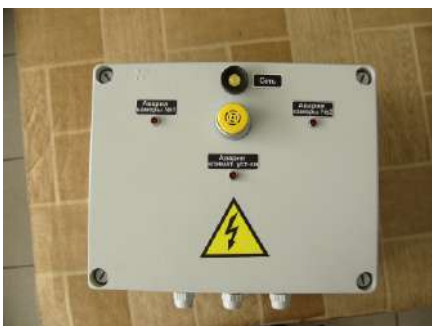
Пост звуковой и световой аварийной сигнализации
