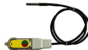
Логгер DLT с внешним датчиком температуры
