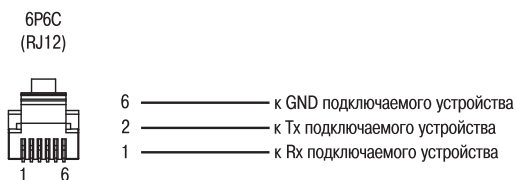
Схема кабеля для подключения к порту Debug RS-232
