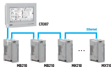
Подключение модулей Mx210 к панели оператора СП307-Р с интерфейсом Ethernet
