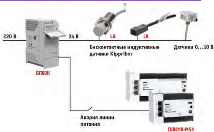
Сигнализация наличия питания для датчиков и актуаторов в ответственных применениях
