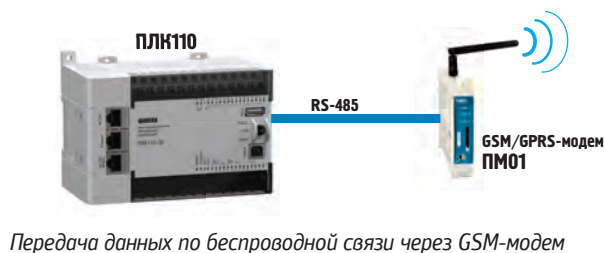
Передача данных по беспроводной связи через GSM-модем
