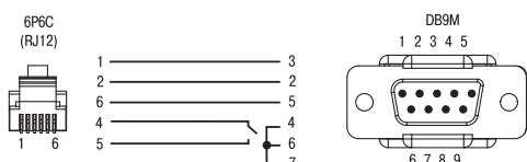
Схема кабеля KC3 «ПЛК-Модем»
