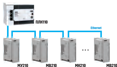
Подключение модулей Mx210 к ПЛК по топологии «цепочка» (Daisy Chain)
