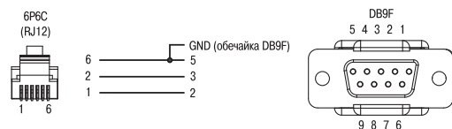
Кабель KC2 для подключения ПЛК100 к панелям ИП320, СП270 и СП3хх (порт RS-232 Debug)
