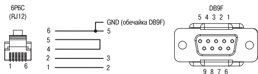
Схема кабеля для программирования КС1, входящего в комплект поставки
