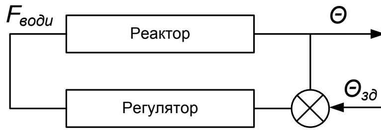
Рис.3.1 Структурна схема контуру регулювання
