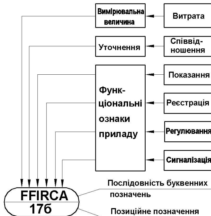
Рис. 2.10 – Приклад побудови умовного літерного позначення приладу індикації, реєстрації, регулювання та сигналізації співвідношення витрат
