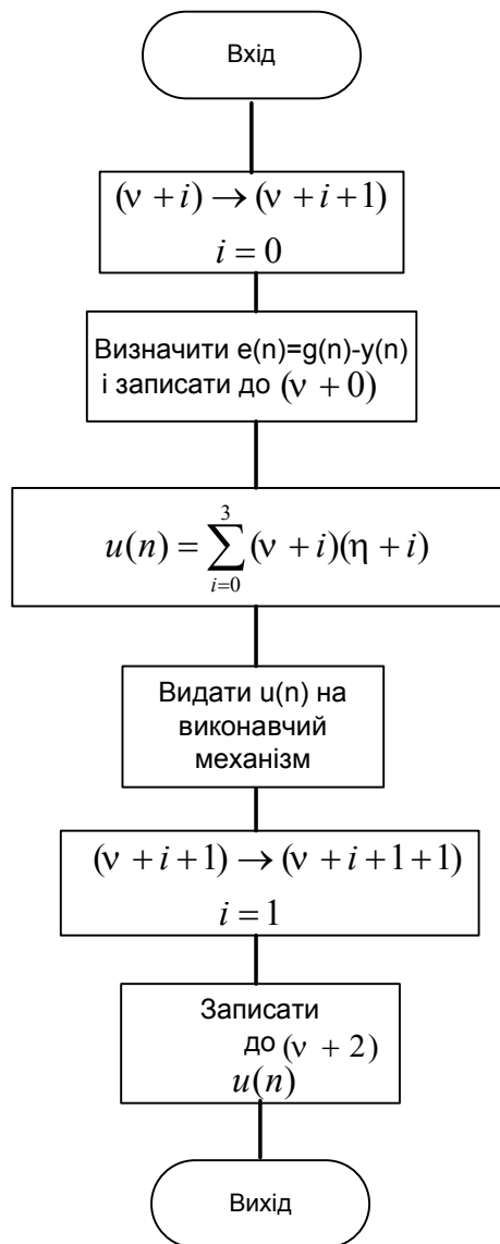
Рис. 3.27. Структура алгоритму регулятора Даліна типу III ( k=1 )
