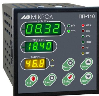
Мікропроцесорний прилад ПП110 для контролю значення рН
