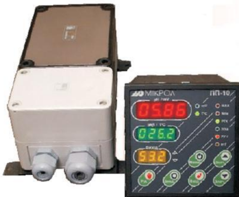
Рис. 4-15. Зображення потенціометричного вимірювача ПП-10 для контролю значення рН.
