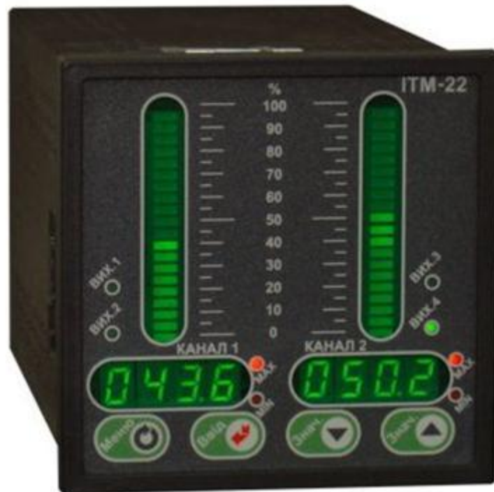
Рис. 4-2. Зображення мікропроцесорного технологічного індикатора ІТМ-22.
