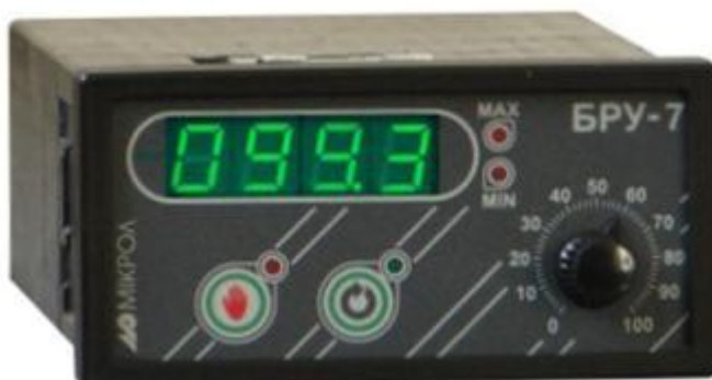
Рис. 4-7. Зображення мікропроцесорного блока ручного управління БРУ-7К1 з живленням постійним струмом у 24 V.
