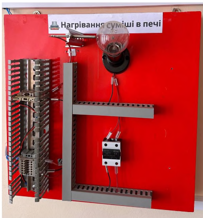
Зовнішній вид імітаційного лабораторного стенда «Нагрівання суміші в печі»
