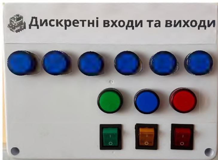
Зовнішній вигляд імітаційного лабораторного стенда «Дискретні входи та виходи»
