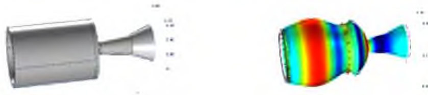
Рис. 2. Складний збірний соноотрод. Загальна мода коливань 20 кГц
