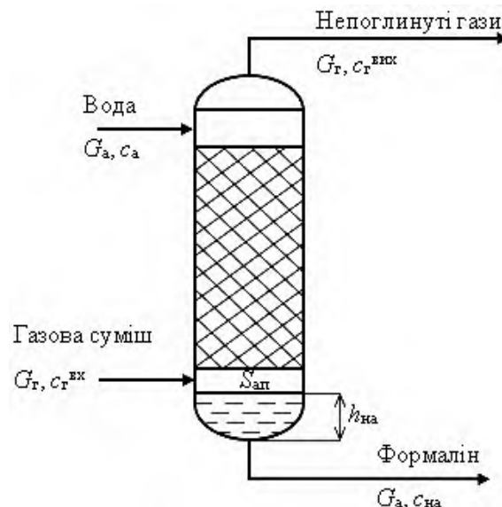
Рис. 1. Розрахункова схема насадкового абсорбера
