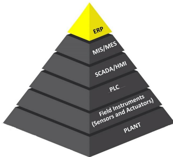
Рис. 1. Структура багаторівневої системи керування
