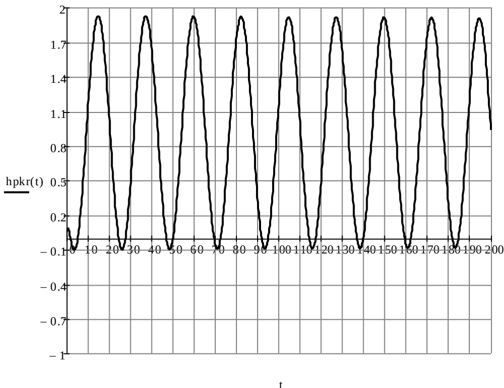
Рис. 2. Перехідна характеристика системи в режимі автоколивань
