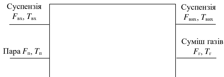
Рис. 2. Параметрична схема випарної колони
