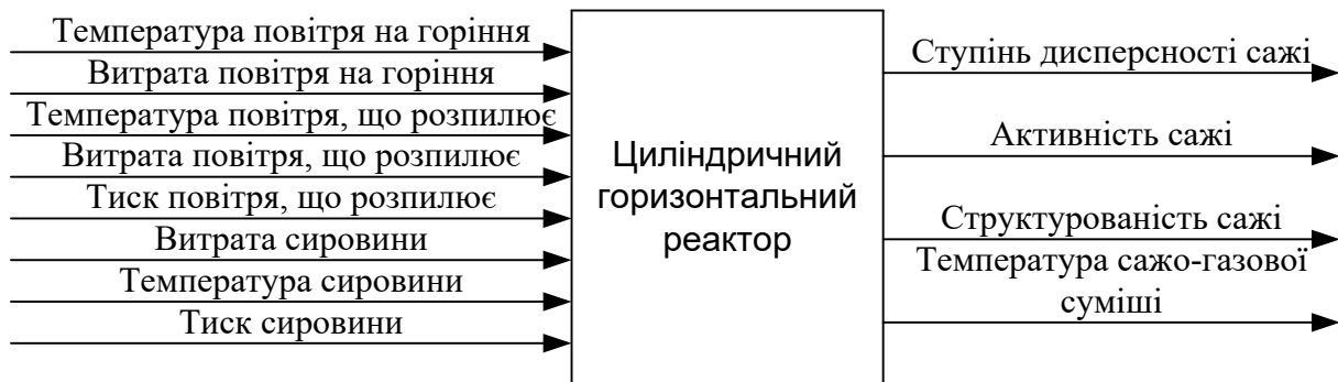
Рис. 2. Параметрична схема циліндричного горизонтального реактора
